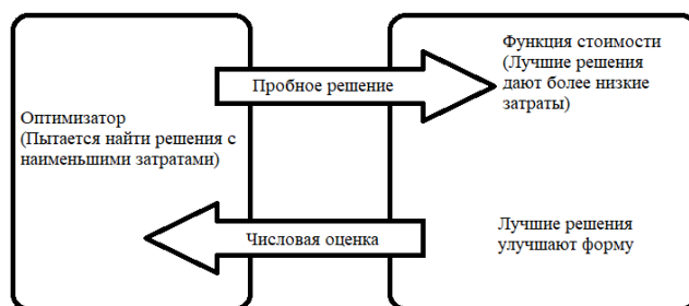
Рис. 1. Оптимизатор постоянно взаимодействует с функцией стоимости для оптимизации решения
