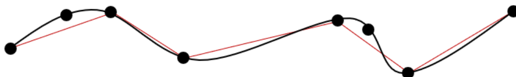
Рис. 3. Пример работы алгоритма РДП
