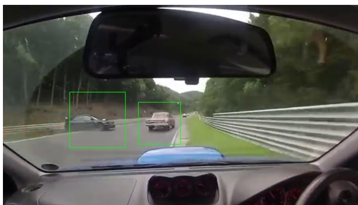
Рис. 3. Пример обнаружения автомобиля с записи видеорегистратора
