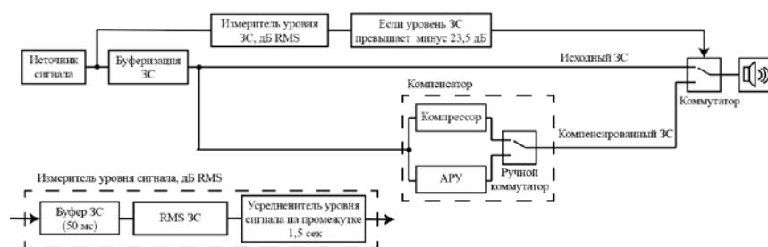
Рис.2. Принципиальная схема компенсатора
