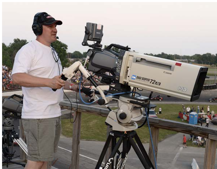
Рис. 1. Камера с длиннофокусным объективом Canon DigiSuper72
