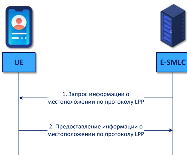
Рис. 2 – Процедура передачи информации о МП, инициируемая E-SMLC
