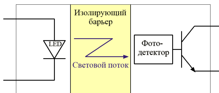
Рис. 2. Схема оптической гальванической развязки
