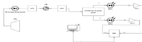
Рис. 3. Упрощенная структурная схема установки для измерения ХД дифференциальным фазовым методом.
