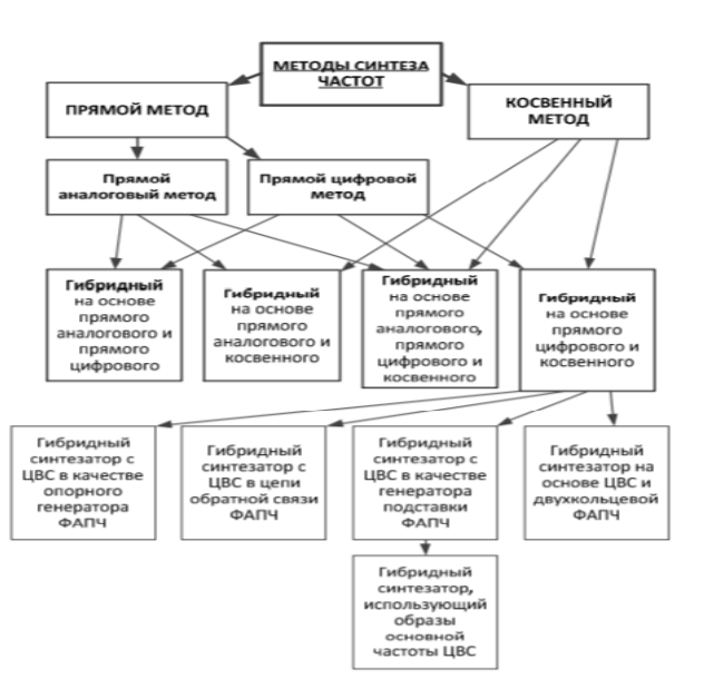
Рис. 1. Способы реализации гибридного синтеза частот
