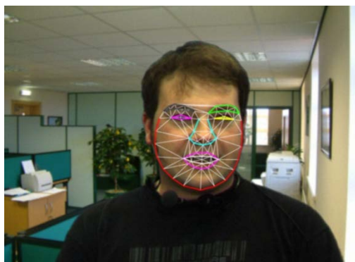
Рис. 2. Процесс распознавания лица программой MMER_FEASy
