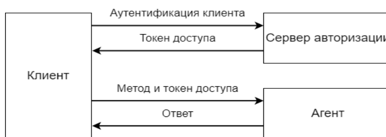
Рис. 1. Схема взаимодействия компонентов
