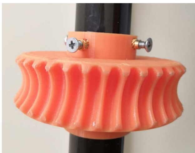
Рис. 4. Червячное колесо на трубе
