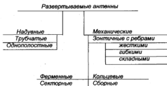
Рис. 2. Классификация антенн по способу укладки зеркала
