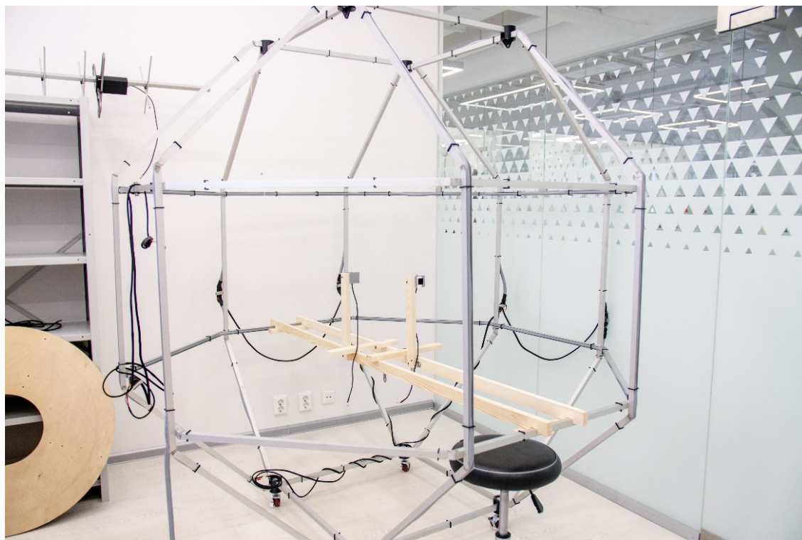
Рис.1. Модель системы формирования магнитного поля Земли
