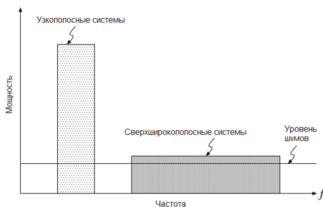
Рис. 2. – Схематическое сравнение узкополосных и СШП систем
