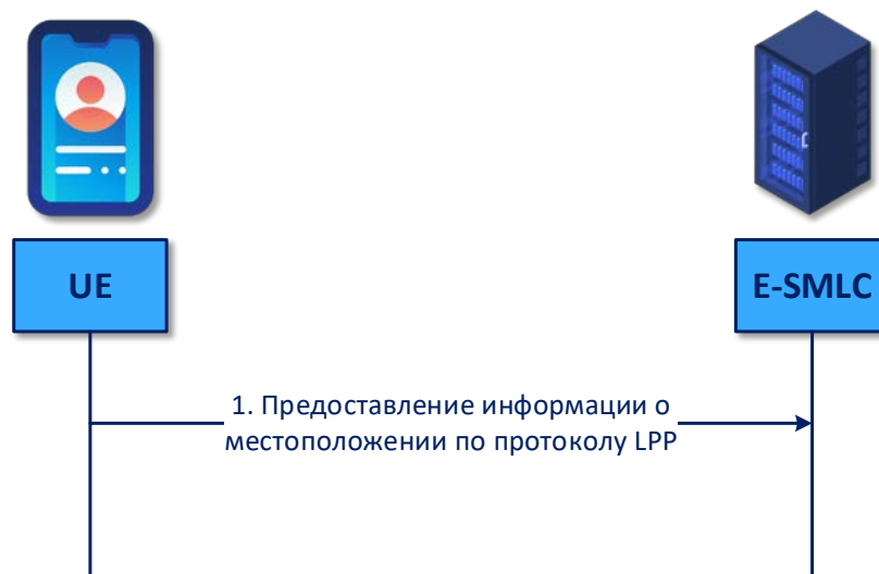
Рис. 3 – Процедура доставки информации о МП, инициируемая UE
